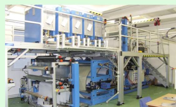
Kontinuální linka výroby iontové selektivní membrán RALEX - MEGA a.s.
